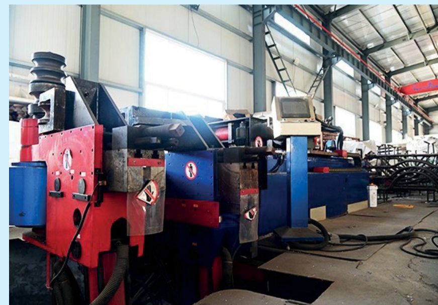
Электрический гидравлический трубогибочный станок с ЧПУ Все литые водопроводные трубы сгибаются в холодном состоянии на трубогибочном станке.
