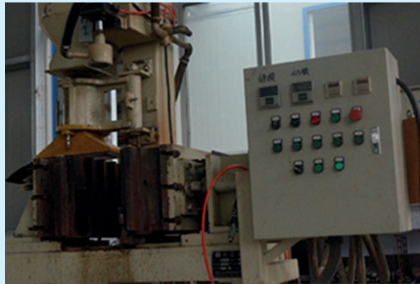
Пескострельная стержневая машина, использующая плакированный песок Используется для создания литейных стержней, таких как, например, болтовых отверстий для холодильных плит.
