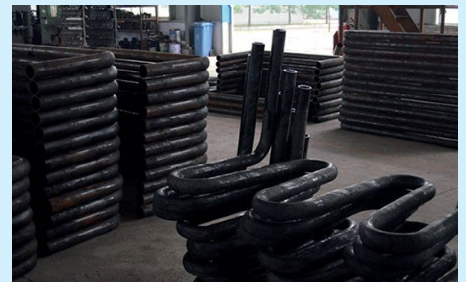
Стальной трубопровод системы охлаждения
